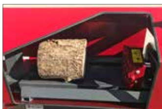
Mit einer Kreuzgriffschraube wird die Länge des Spaltweges auf die gewünschte Scheitlänge eingestellt.
