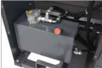
Durch den großen Hydraulik-Vorrats- tank bleibt das Öl auch bei Dauer- einsatz in der Temperatur konstant.
