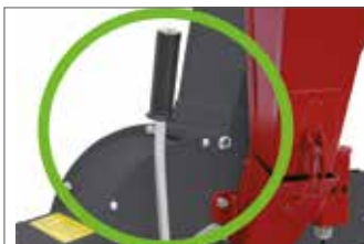
Durch den seitlich angebrachten Handbedienungshebel kann das Langlochgitter geöffnet werden. Bei Verstopfungen kann die Maschine somit einfach und flott gereinigt werden.
