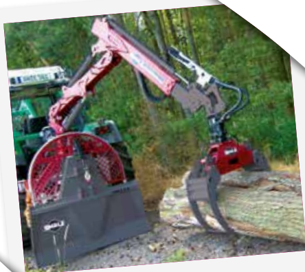
Rückekran in Kombination mit Forstseilwinde mit Zapfwelldurchtrieb möglich.
