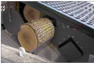
Eine hydraulische Schiebevorrichtung dient als Holzabrollbremse. Auch kürzer abgesägte Stammstücke werden exakt und gerade in den Spaltkanal abgerollt.
