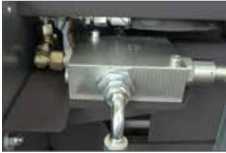
SSM 270 EZ: Ventil (Differentialventil) für höhere Spaltgeschwindigkeit
