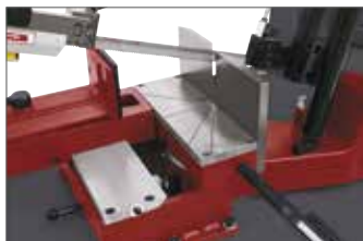
Die Gehrungspositionen 90°, 45° und 60° exakt einstellbar.
