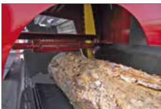
Die Andrückwalze klemmt mittels Hydraulikzylinder den Stamm fest. Dadurch ist ein sicherer Schnitt beim Absägen der letzten Stammstücke möglich.
