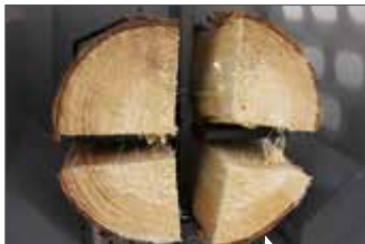
4-er Spaltkreuz: Gleichmäßig große Scheite sind das Resultat.
