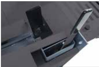
Das Spaltkreuz lässt sich über einen Bedienhebel schnell und sicher auf die gewünschte Höhe justieren.
