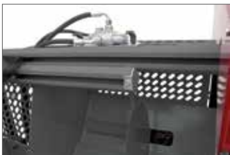
Das Zuführband wird über ein Hydraulikventil in Stopp-Stellung geschaltet. Durch Verschieben des Ventils kann vor Arbeitsbeginn die gewünschte Scheitlänge (200 bis 660 mm) eingestellt werden.
