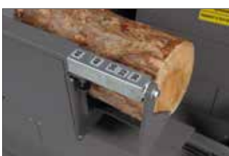
Einstellbare Scheitlänge (250 – 500 mm)
