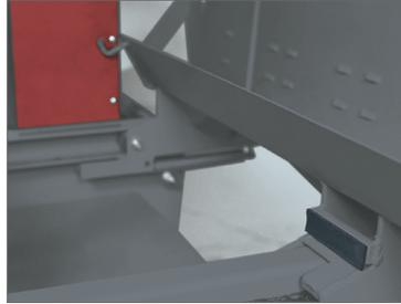
Die Holzscheite werden horizontal über eine kugelgelagerte Holzzuführung in Rinnenform zum Sägeblatt geschoben.
