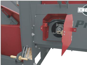
Die Arbeitsschutzbestimmungen nach CE sind in vollem Umfang gewährleistet. Der E-Motor der PC 704 EZ/4 kann nur bei geschlossenem Zapfwellenantrieb betrieben werden.
