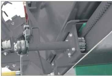
Die Modelle PC 704 Z/4 und PC 704 EZ/4 sind mit einem teleskopierbarem Förderband ausgestattet. Das Teleskopieren wird mittels Zahnstangen und Handkurbel durchgeführt.
