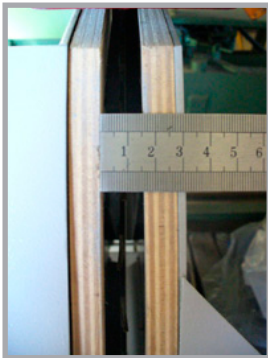
Fig. 2 „Max clearance between inserts“
