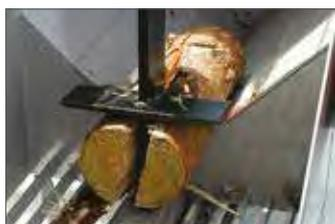
Auch schwaches, krummes oder etwas unförmiges Holz wird durch die V-förmige Spaltmulde gerade gerichtet und mittig zum Spaltmesser gedrückt.
