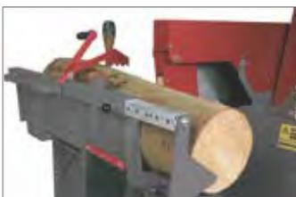
Die Scheitlänge ist von 250 bis 500 mm einstellbar. Das ausziehbares Vierkantrohr wird auf die gewünschte Länge eingestellt und mittels Federbolzen fixiert.
