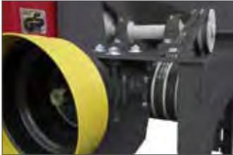
Die Schleppersäge ZWK 710/2 ist mit Winkelgetriebe ausgestattet – die Kraftübertragung zur Sägewelle erfolgt bei beiden Modellen über Keilriemen. Günstige Übersetzung! Volle Umdrehungszahl am Sägeblatt schon bei 500 U/min. der Zapfwelle!
