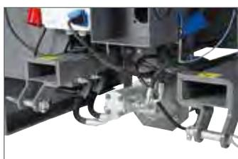
Stabile Rechteck-Profile sind für den bequemen Transport mit Gabelstapler vorgesehen. Diese sind für den Transport per Traktor mit der Unterkeraufhängung verbunden.
