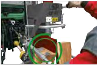
Während links mit dem beweglichen Bedienhebel der Holzstamm mittig zum Spaltmesser ausgerichtet wird, schaltet man rechts den Zylindervorschub über das Hydro-Ventil. Die Doppelfunktion des linken Bedienhebels hat den Effekt einer dritten Hand.
