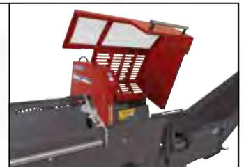
Durch Hochklappen des Schutzgitters wird das Auslösen des Spaltzylinders zur Sicherheit des Bedieners verhindert und das Sägeblatt ist durch ein Schutzblech komplett abgedeckt.
