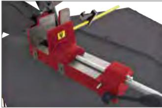
**Schnellspannschraubstock mit Rundstangenführung. Klemmung durch Exzentrerspannhebel.**
