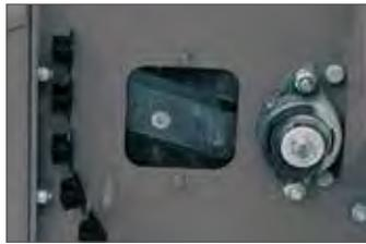
Die Anzahl der scharfkantigen Vierkantstäbe am Flugkreis der Schlaghämmer bestimmen die Feinheit des Materials. Durch Herausnehmen einzelner Vierkantstäbe wird das Material gröber. Das Auswechseln von Schlaghämmern und Schneidmessern ist durch die Serviceöffnung problemlos möglich.
