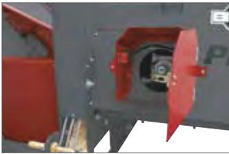
Die Arbeitsschutzbestimmungen nach CE sind in vollem Umfang gewährleistet. Der E-Motor der PC 704 EZ/4 kann nur bei geschlossenem Zapfwellenantrieb betrieben werden.
