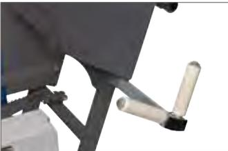
Ausziehbare Rollen für Holzzuführung, zum Sägen von Holzstammlängen bis zu 2,50 m.
