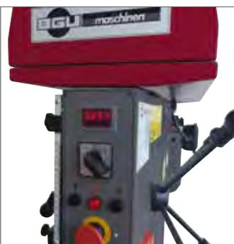
Digitalanzeige für die Bohrspindel-drehzahlen
