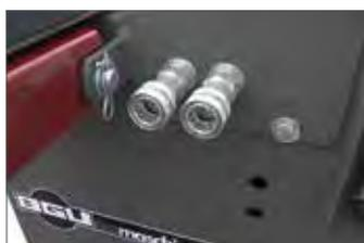
Hydraulische Schnellkupplung. Anschlussmöglichkeit für Holz-zuführbock. Bedienung über Multifunktionshebel, zur Längsförderung einer Sternradwalze.
