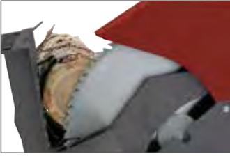
Ohne großen Kraftaufwand lässt sich die Wippe mit dem Holzstamm ins Sägeblatt kippen. Durch die Konstruktion wird eine hohe Schnitttiefe mit dem Sägeblatt von 700 mm Durchmesser erreicht.
