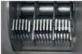
Die pendelnden Schlaghämmer an der Trommel sind durch Wenden 2-fach einsetzbar. Schlaghämmer und Messer sind aus hochwertigem Spezialstahl. Die Aufhängebolzen sind aus vergütetem Stahl und oberflächengehärtet, um ein Einlaufen der Hämmer auf denselben zu verhindern.
