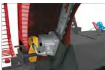
Die Sägekette wird erst nach Abwärtsbewegung des Multifunktionshebels (kurz vor dem Eintauchen in den Holzstamm) in Betrieb gesetzt. Unnötiger Ketten- und Schienenverschleiß ist daher ausgeschlossen.
