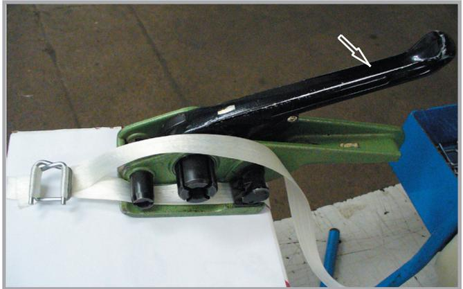
5. Führen Sie dann den Hebel wieder nach oben und legen Sie nun das obere Band in die Schneidvorrichtung und die Spannklaue wie in Abb.5 erkennbar ist.
