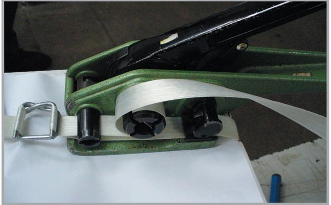
**6.** Nun können Sie mit einem kurzen Hebeldruck nach unten das Band abschneiden (siehe Abb.7)
